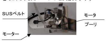
②下部プーリの取外し プーリ軸のE型止め輪を取外し、SUS ベルトから下部プーリを外します。
